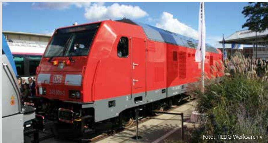
FORMNEUHEIT Diesellok BR 245 der DB AG NEW Electric locomotive class 245 of the DB AG
