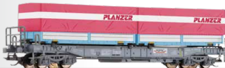
Taschenwagen der HUPAC, beladen mit zwei Wechselpritschen der Planzer Transport AG Pocket wagon of the HUPAC with load
